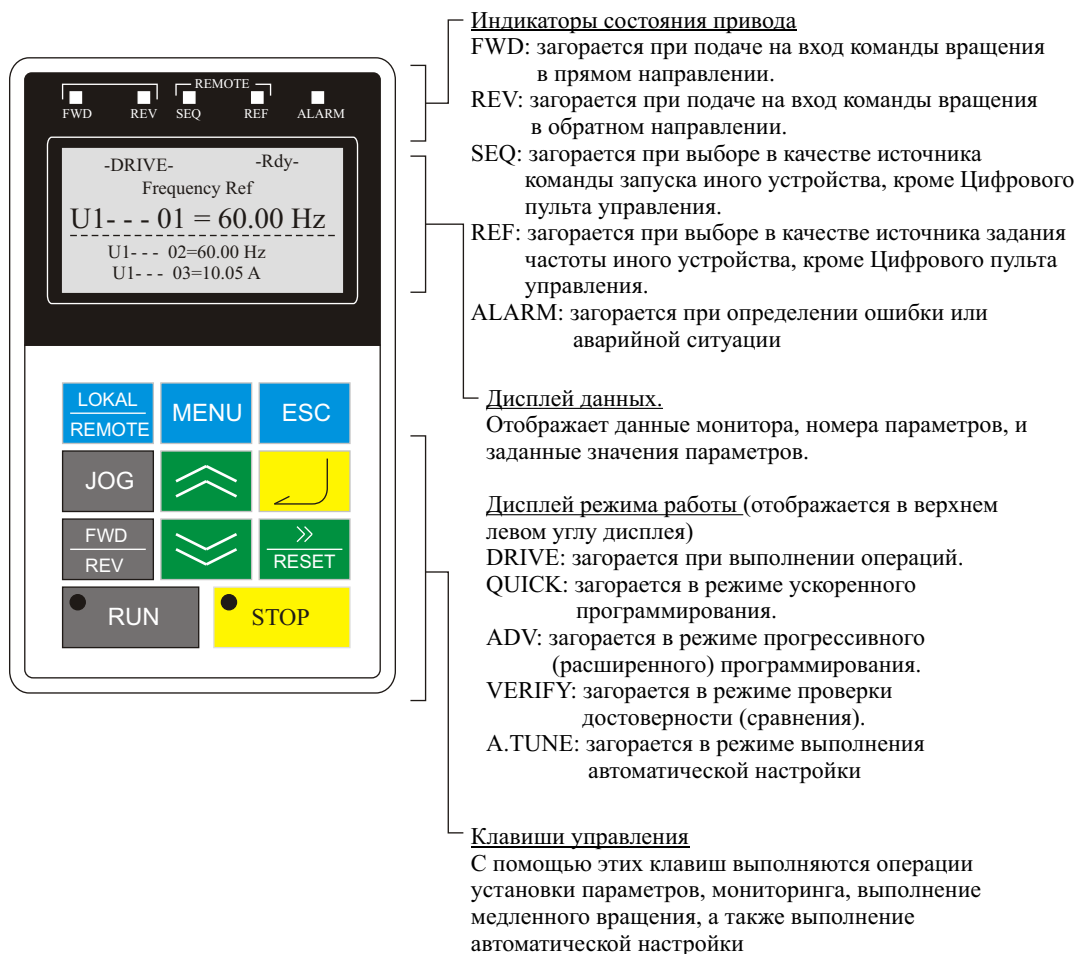
Рис. 3.22 Наименование компонентов Цифрового пульта управления и их функции.
